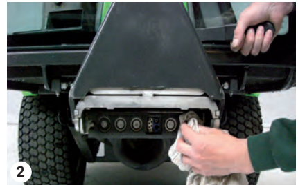
2 Почистване на куплунги с ключалка – А-образна рама
