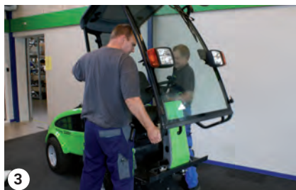
Повдигане на кабината/ролбара
