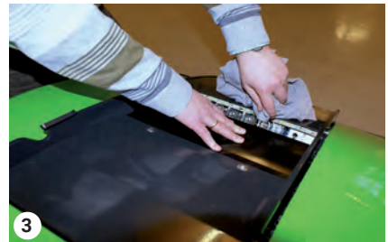
3 Почистване на куплунги с ключалка – В-образна рама
