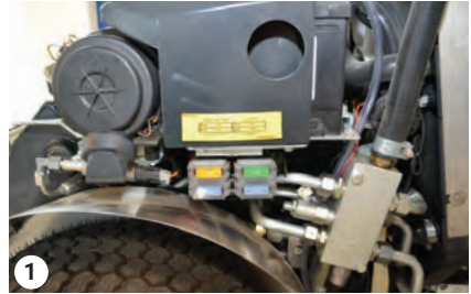
60 A JF15 генератор - 60 A JF1 захранваща кутия с предпазители 20 A JF2 аварийна линия - 30 A JF3 мощност на двигателя
