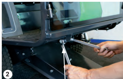
Болтове под опорната плоча
