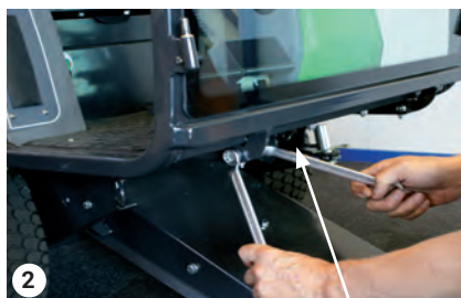
Болтове под опорната плоча
