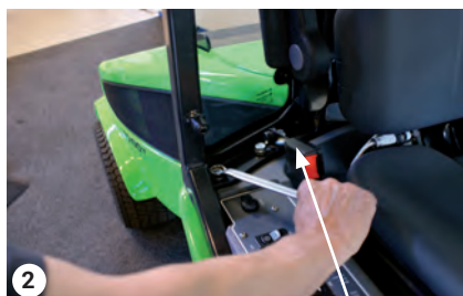
Разхлабете двата болта, разположени на всяка страна
