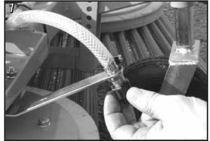
Reinig straalpijpen / vervang filters
