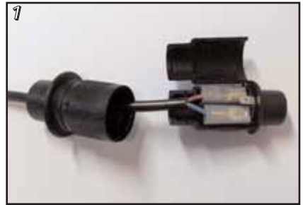
Bruine kabel naar + en blauwe kabel naar -
