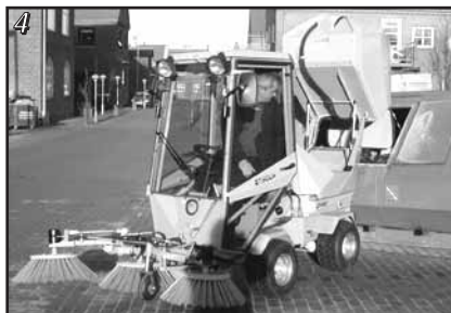
Legen van de container
