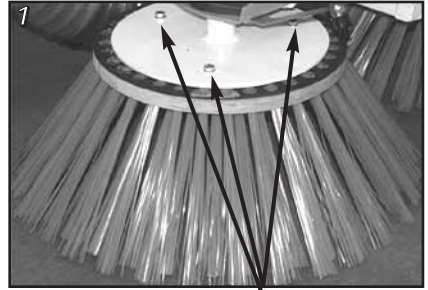
Borstels vervangen: draai de bouten los
