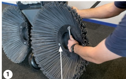
Výměna kartáčů: povolené šrouby
