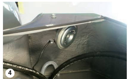
4 Zkontrolujte, že je konektor připojen k reproduktoru.
