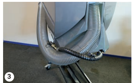
Skladování hydraulických a vodních hadic
