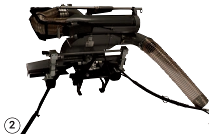
Před připojováním rozložte sací hadici a hydraulické hadice na strany.
