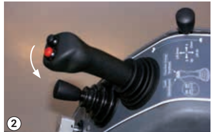
2 Seřizovací rukojeť – Snížení výšky sečení
