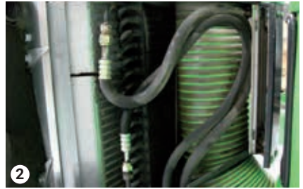
Chladiče umyjte čistou vodou
