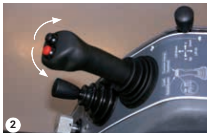
Joystick – naklonění/spuštění sekačky.
