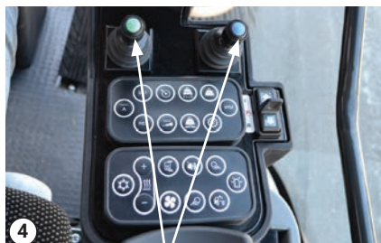
Natáčení radlice na sníh tvaru V Zvedání/spouštění radlice na sníh tvaru V
