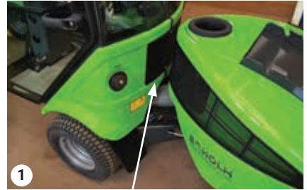
1 Kabinen-Luftfilter hinter dem Gitter
