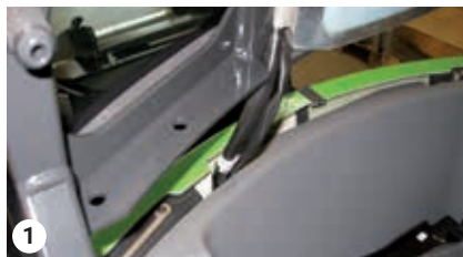
Leitungen nach unten ziehen
