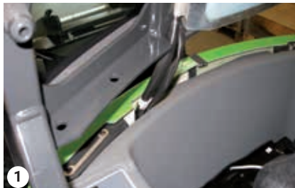
Leitungen nach oben ziehen
