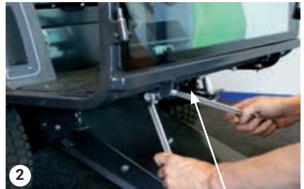
Bolzen unter der Bodenplatte
