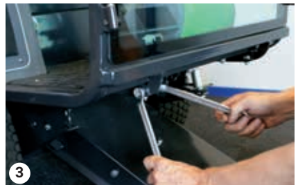
Bolzen unter der Bodenplatte
