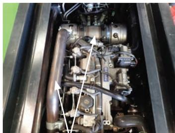
Auspuffrohr und D.O.C.
