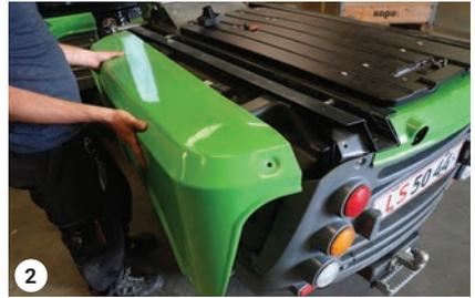
Zugang zu: Batteriefach
