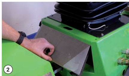
Einbau der Ölkühlerabdeckung
