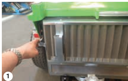
1 Abbau der Wasserkühlerabdeckung
