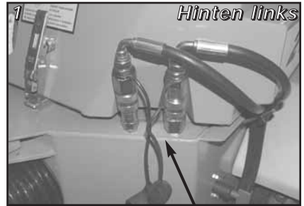
Hydraulikschläuche des Heberahmens auf den C-Anschlüssen
