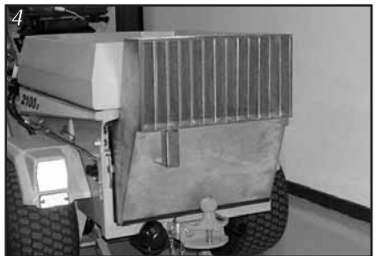
Großer Schirm für den Wasserkühler
