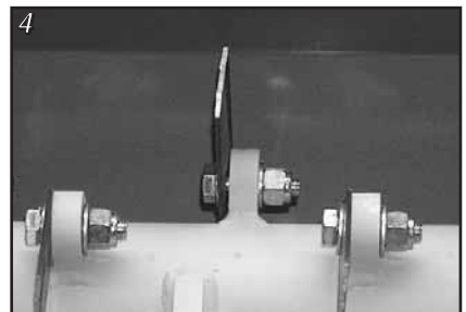
Die Vertikutiermesser sind einzeln einzusetzen.
