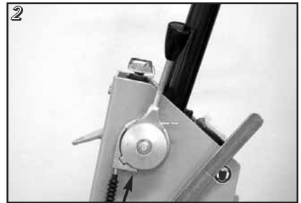
Drehen Sie den Gashebel, bis er halb geöffnet ist.
