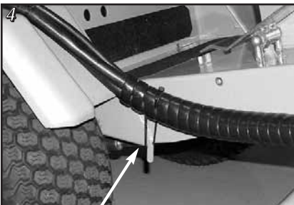
Schläuche werden mit einem Gummiring befestigt.
