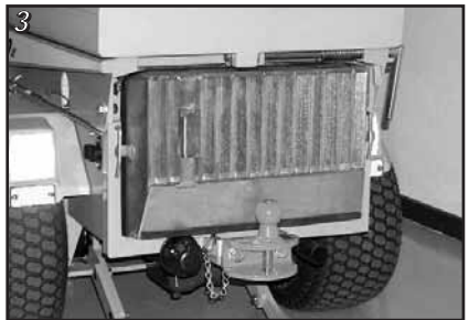
Schirm für den Wasserkühler
