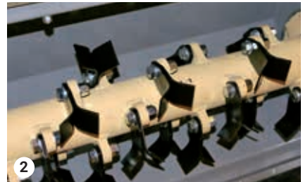
Überprüfung der Messer
