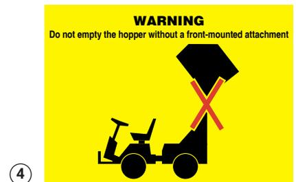
Den Grassammelbehälter niemals ohne montiertes Frontanbaugerät entleeren.
