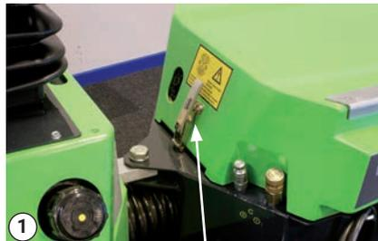
Die Verriegelung der Motorabdeckung muss geschlossen sein!
