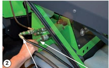
Ölüberlaufschläuche an Anschluss D-3 Anschluss D-1
