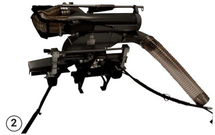
Saugschlauch und Hydraulikschläuche vor dem Anbau seitlich auslegen.
