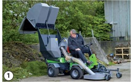
Der Grassammelbehälter verfügt über ein Schlauchbruchventil, das aktiviert werden könnte, falls der Grassammelbehälter zu schnell abgesenkt wird. Wurde das Schlauchbruchventil aktiviert, den Grassammelbehälter wieder anheben und dann langsam absenken.
