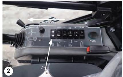
Vordere Zapfwelle und Gashebel
