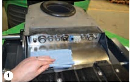
1 Die Schnellkupplungen mit einem Tuch reinigen
