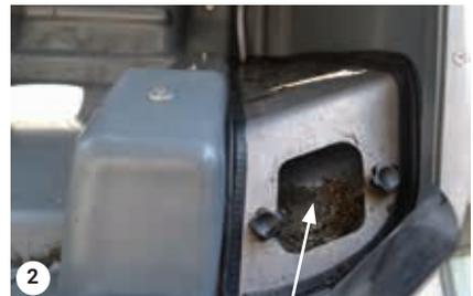
2 Die Klappen an allen Filtern entfernen.
