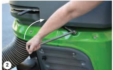
Der Sperrhebel wird gedreht
