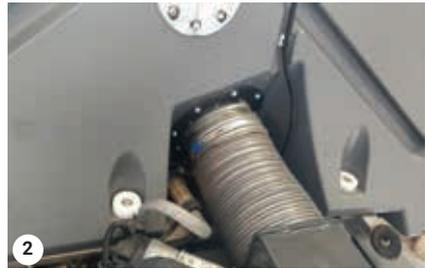
2 Den externen Schlauch durch Lösen der Schlauchklemmen abschließen.
