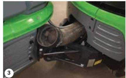
Den Schlauch an der Gelenkverbindung reinigen
