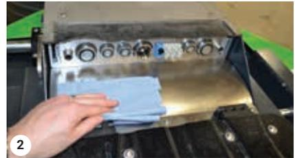
2 Reinigen der Anschlüsse
