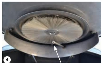
4 Wassersprüher im Kehrgutbehälter
