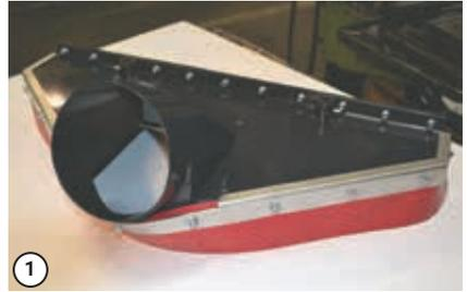
Alle Bolzen an der hinteren Dichtung aufschrauben und die Dichtung austauschen
