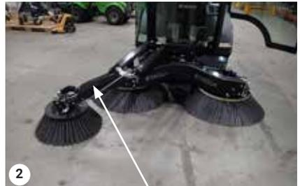
Abdeckung entfernen (Bürste in ausgefahrener Position)
