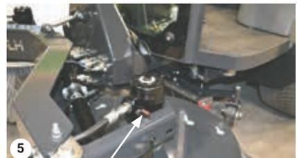
5 Ventil an der vorderen Bürste für 3. und 4. Düse angebracht
