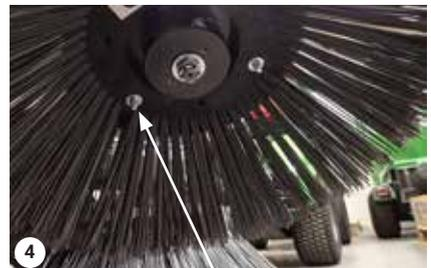
Die 3 Muttern lösen und die Bürste ersetzen
