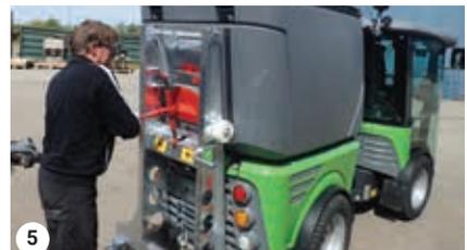
5 Den Anbaurahmen andrücken und sicherstellen, dass die Haken an den Hebevorrichtungen richtig angebracht sind.
