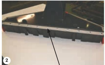
Alle Bolzen an der vorderen Dichtung aufschrauben und die Dichtung austauschen
