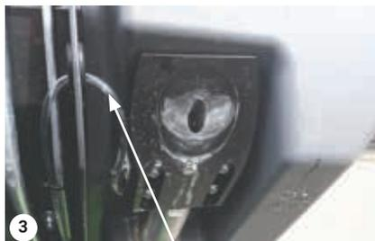
Den Schlauch lösen, Restwasser ablassen
