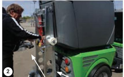
Den Kehrgutbehälter mit der Lastspindel auf den Rahmen absenken
