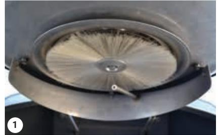
1 Überprüfen des Drehfilters und der Turbine
