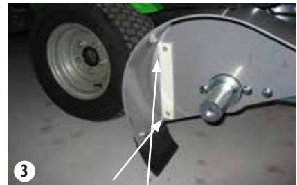
Schrauben, mit denen die Verschleißleiste befestigt ist
