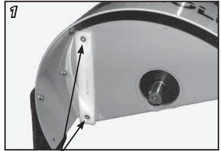
Schrauben für die Befestigung des Schleifklotzes.
