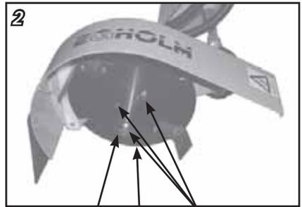
Achse, Schneidplatte und Bolzen
