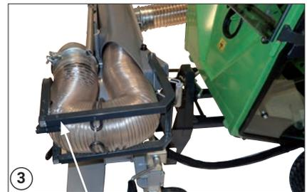
Den Griff um den Laubsaugschlauch legen und verriegeln.
