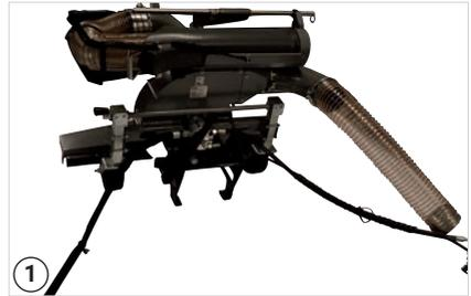
① Den Saugschlauch und die Hydraulikschläuche vor dem Anbau seitlich auslegen
