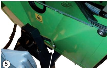
⑤ Sicherungshebel für Anbaugerät – verriegelt
