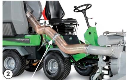
Den Saugschlauch mit Hilfe der Schlauchschele anschließen
