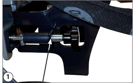
1 Sicherungsstift geöffnet – Laubsauger im Schwimmstellung
