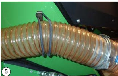
Saugschlauch mithilfe des Gummispannriemens für Geräteträger mit Kabine befestigen
