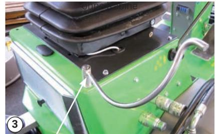
Schlauchaufhängung am Gewindestift rechts hinter dem Sitz montieren
