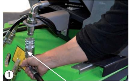
Rücklaufschlauch vom Laubsauger
