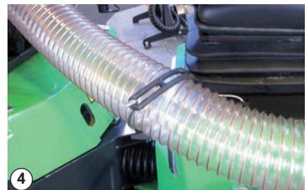
Saugschlauch mit Hilfe des Gummispannriemens für Geräteträger ohne Kabine befestigen
