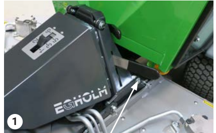
Griff in oberer Position für Kippvorgang.
