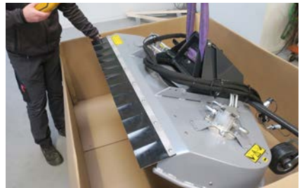
Mäher mit Kran oder Gabelstapler herausheben
