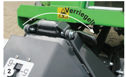
Verriegelung am Frontkuppeldreieck (unverriegelt)
