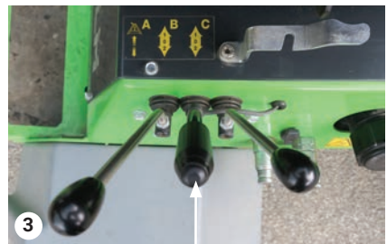
Senken der Schnitthöhe - Einstellgriff. Position 2
