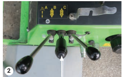
Anheben der Schnitthöhe - Einstellgriff. Position 1
