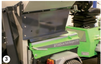
Das Salz- und Kiesstreugerät wird abgesenkt
