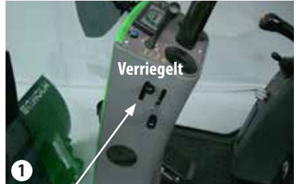
Transportverriegelung in verriegelter Stellung.
