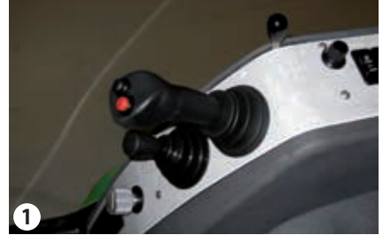
Schneeräumschild mit dem Joystick anheben.
