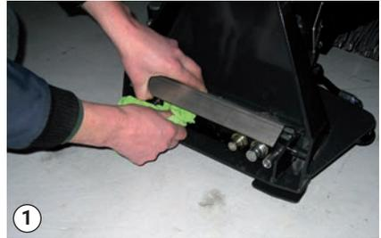
Die Kupplungen mit einem Tuch reinigen
